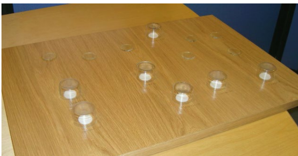
Filterrondeller med vätska på den provade ytan. Rondellerna täcks med en glaskopp för att vätskan inte skall dunsta.
